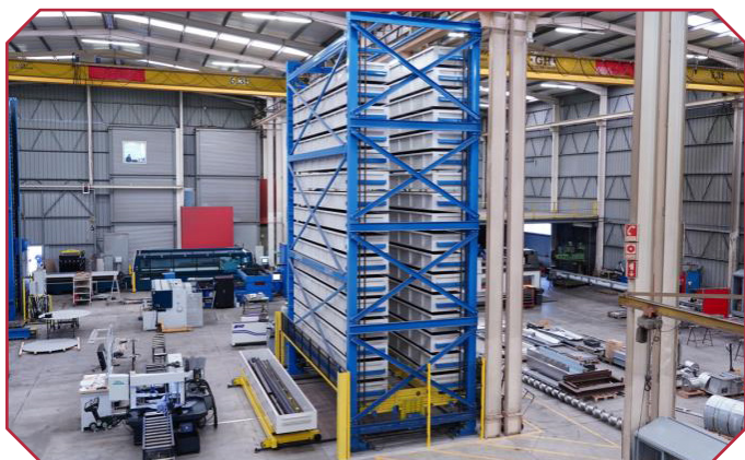
Almacén automático de doble torre con estación de carga y descarga frontal móvil
